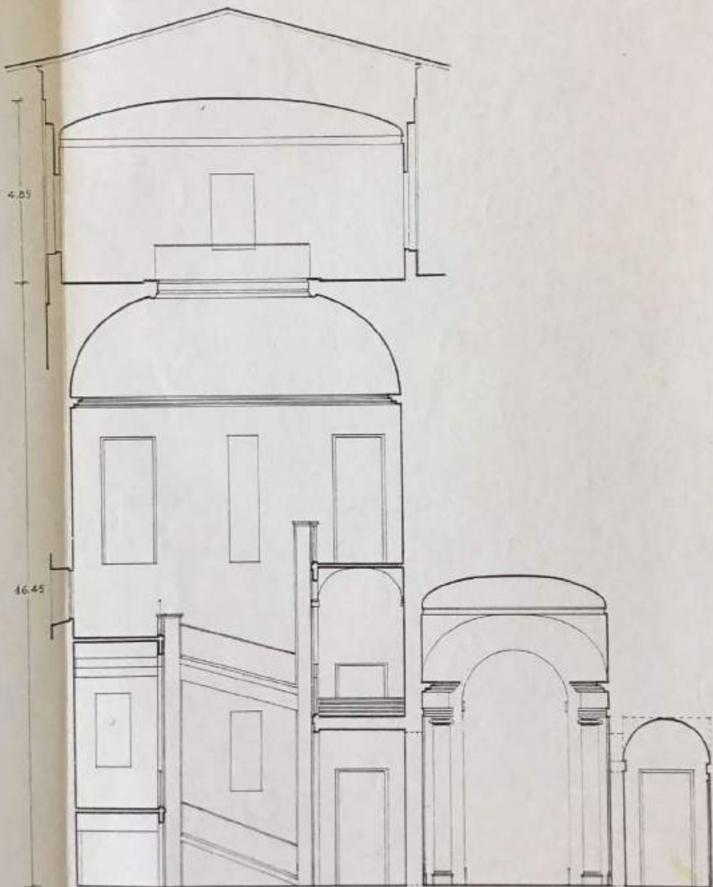
417 - Sezione schematica dello scalone e dell'atrio. Scala 1/100.
