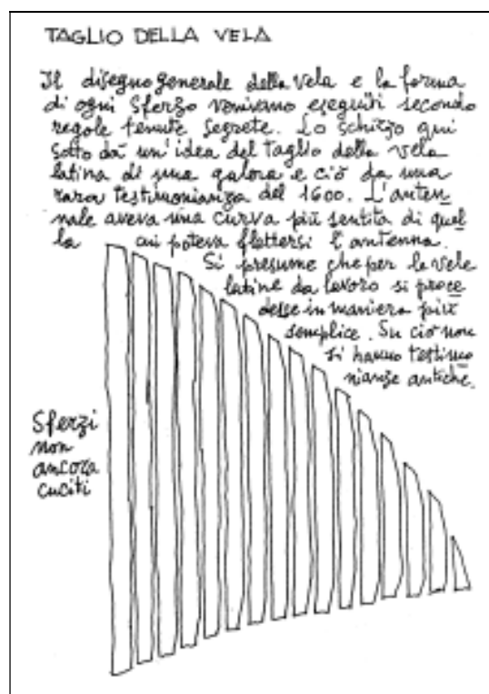
Disegno sommario di vela latina e schema di taglio dei ferzi che la compongono (da Siro Ricca Rosellini, Dalla vela latina alla vela al terzo dell'Adriatico , «La ricerca folclorica», numero speciale su La cultura del mare , n. 21 (aprile 1990).
